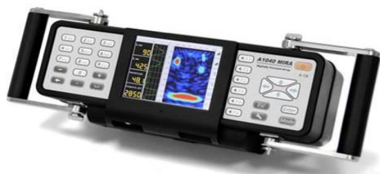
Foto 13: Ved lagtykkelsesmålingerne blev anvendt Teknologisk Instituts ultralydsmåler til lagtykkelsesbestemmelse (venstre billede). Udstyret udsender elektroniske ultralydssimpulser og kan bestemme lagtykkelse med god præcision ud fra tilbagestrålingen fra underlaget.
