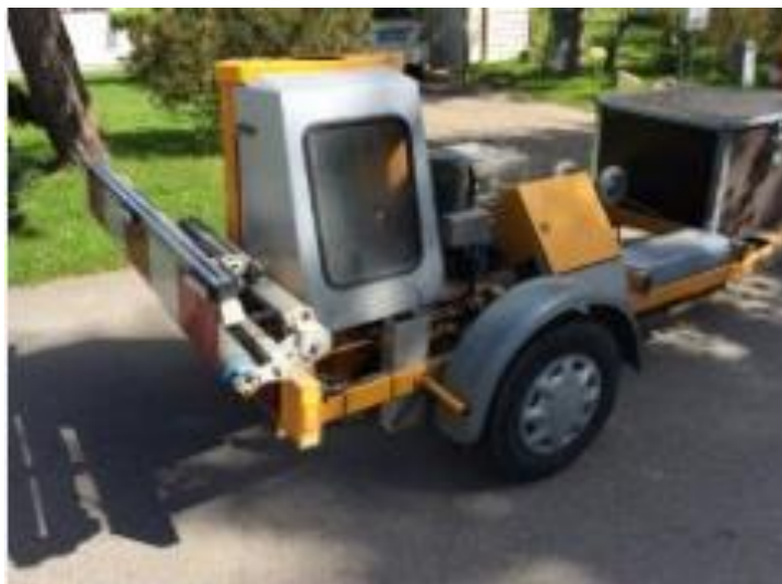
Foto 18: Vejens bæreevne bestemmes ved hjælp af faldlods-måling. Under traileren er placeret en arm med 7 geofoner som registrerer nedsynkningen når faldloddet slår på belægningen. Ud fra nedsynkningerne og de målte lagtykkelser kan materialestivheden og dermed bæreevnen beregnes. Dette anvendes til den efterfølgende beregning af vejens forstærkningsbehov
