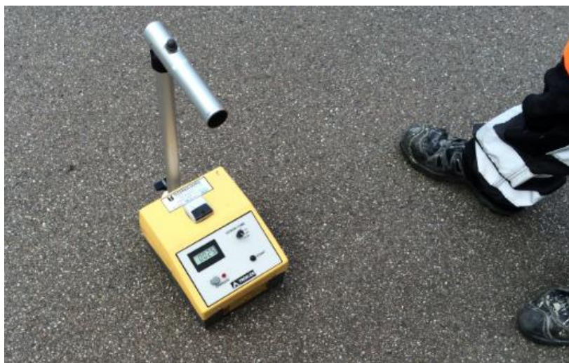
Foto 11: Vandindholdsbestemmelse med Troxler isotopmåler.
